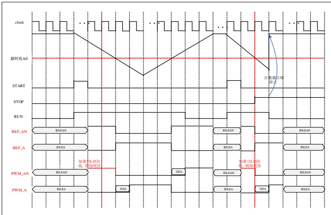
图 6-49 非对称中心对齐模式下计数器启动与停止波形
