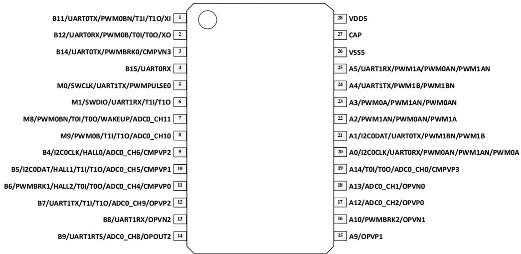
图 5-2 G6S7 封装管脚配置图
