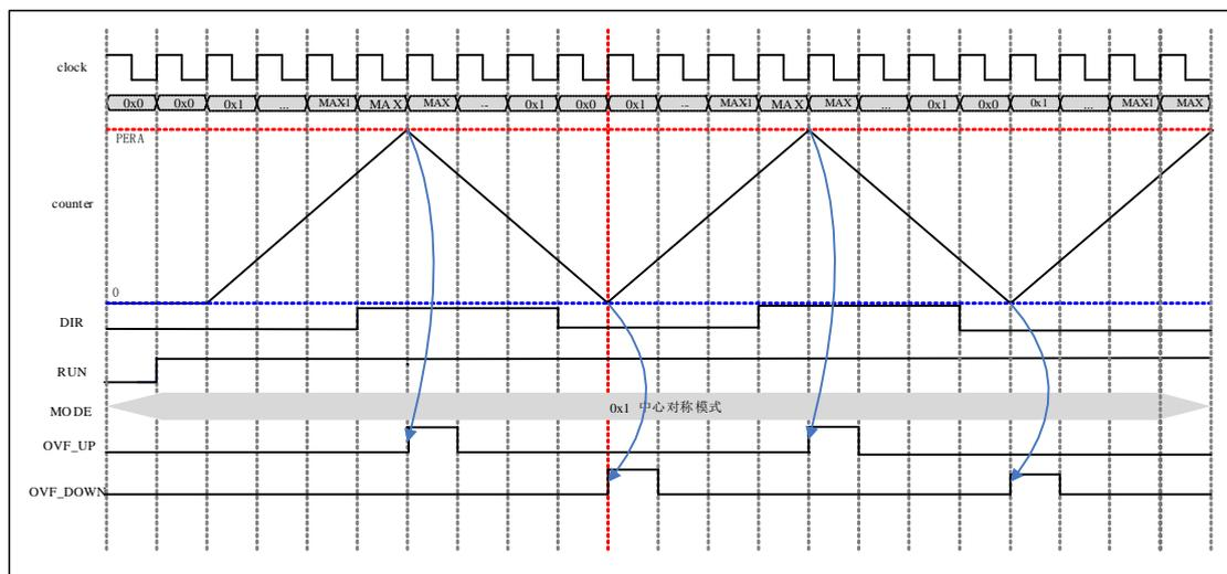
图 6-51 中心对称模式下计数器计数过程波形
