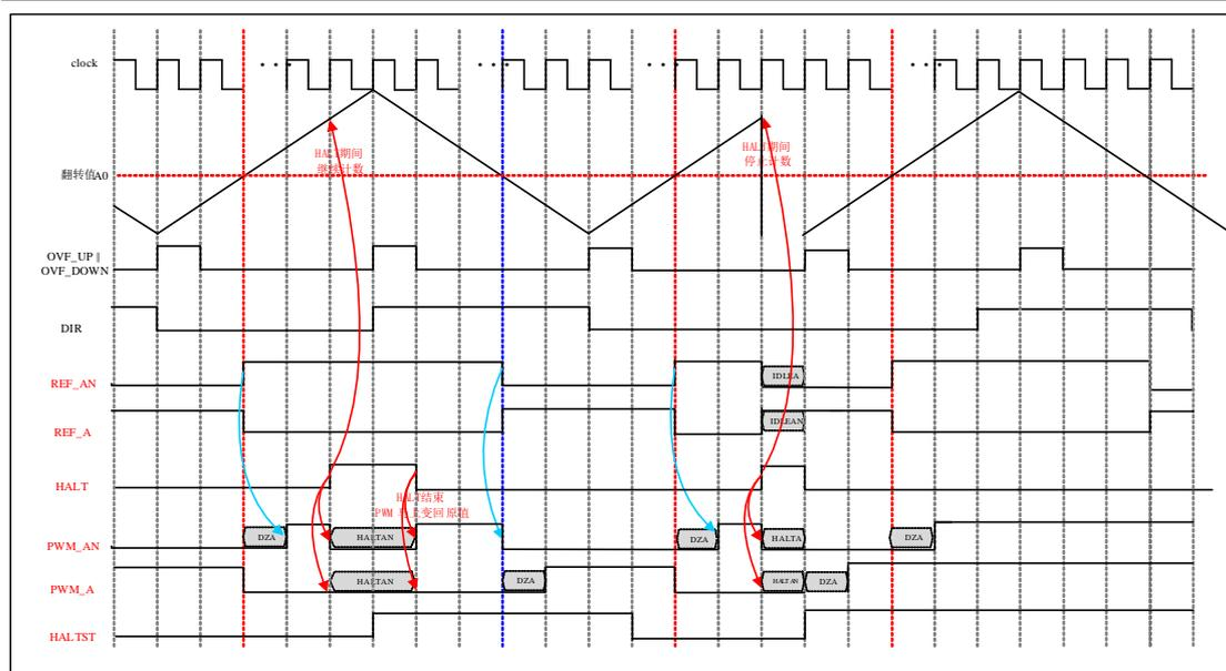
图 6-57 BRK 中心对齐模式下 PWM 信号产生波形
