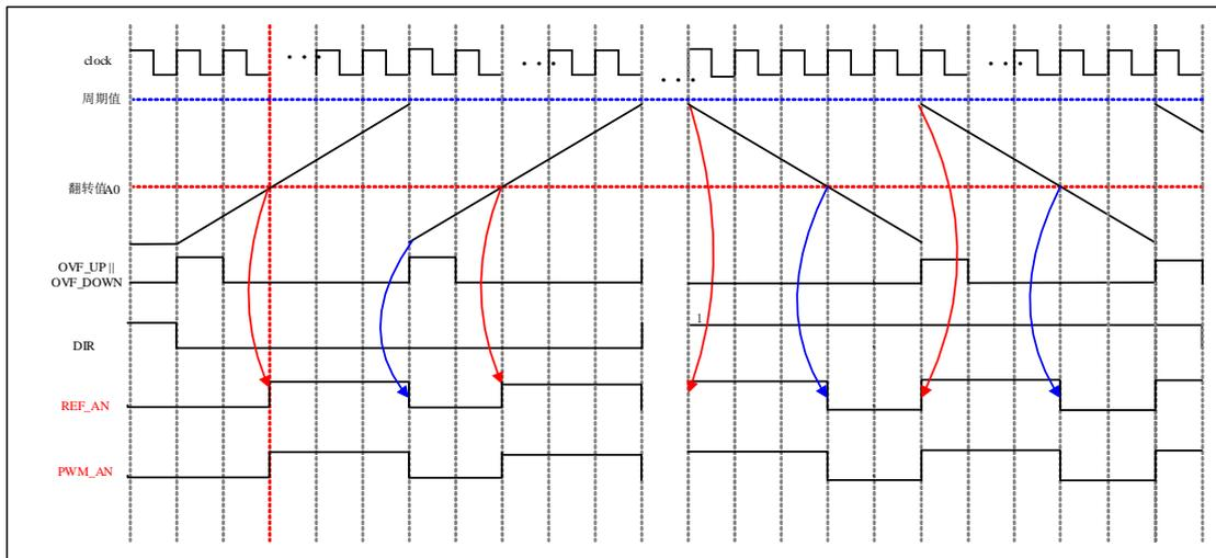
图 6-54 边沿对齐模式下 PWM 信号产生波形
