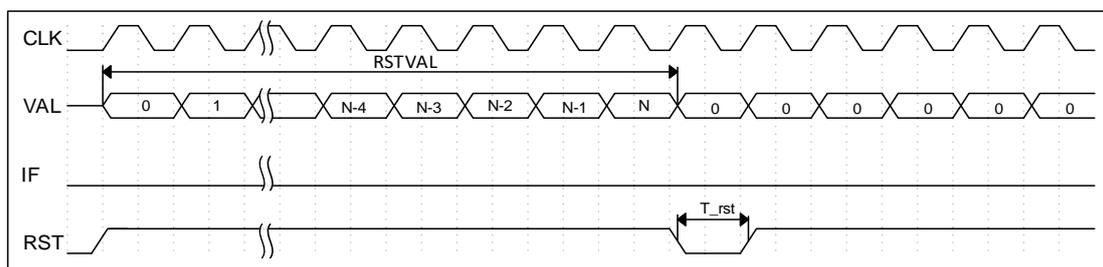
图 6-25 WDT 配置为 RESET 模式波形图
