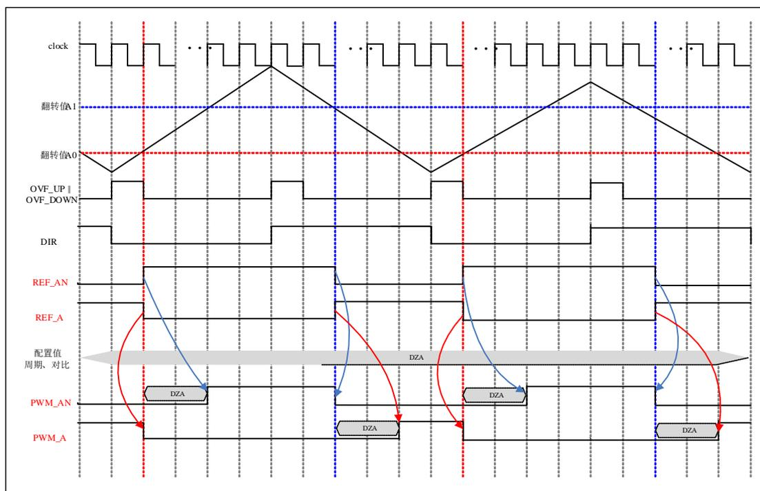
图 6-56 非对称中心对齐模式下 PWM 信号产生波形
