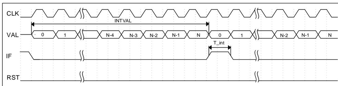
图 6-26 WDT 配置为中断模式波形图
