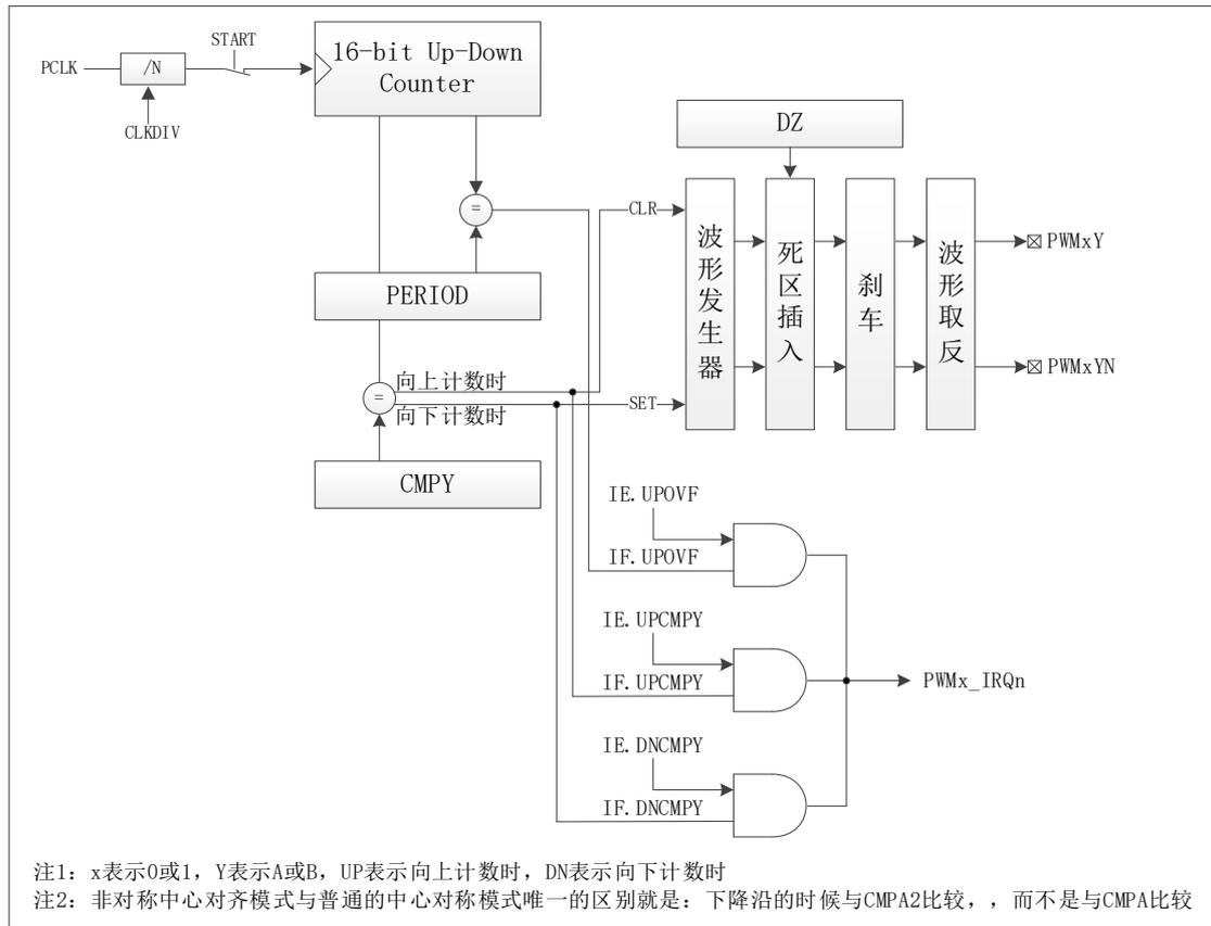
图 6-44 PWM 模块结构框图
