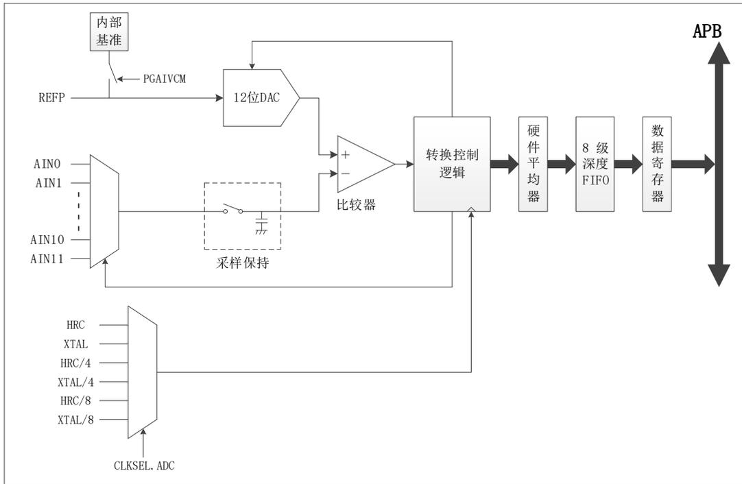
图 6-64 ADC 模块结构框图
