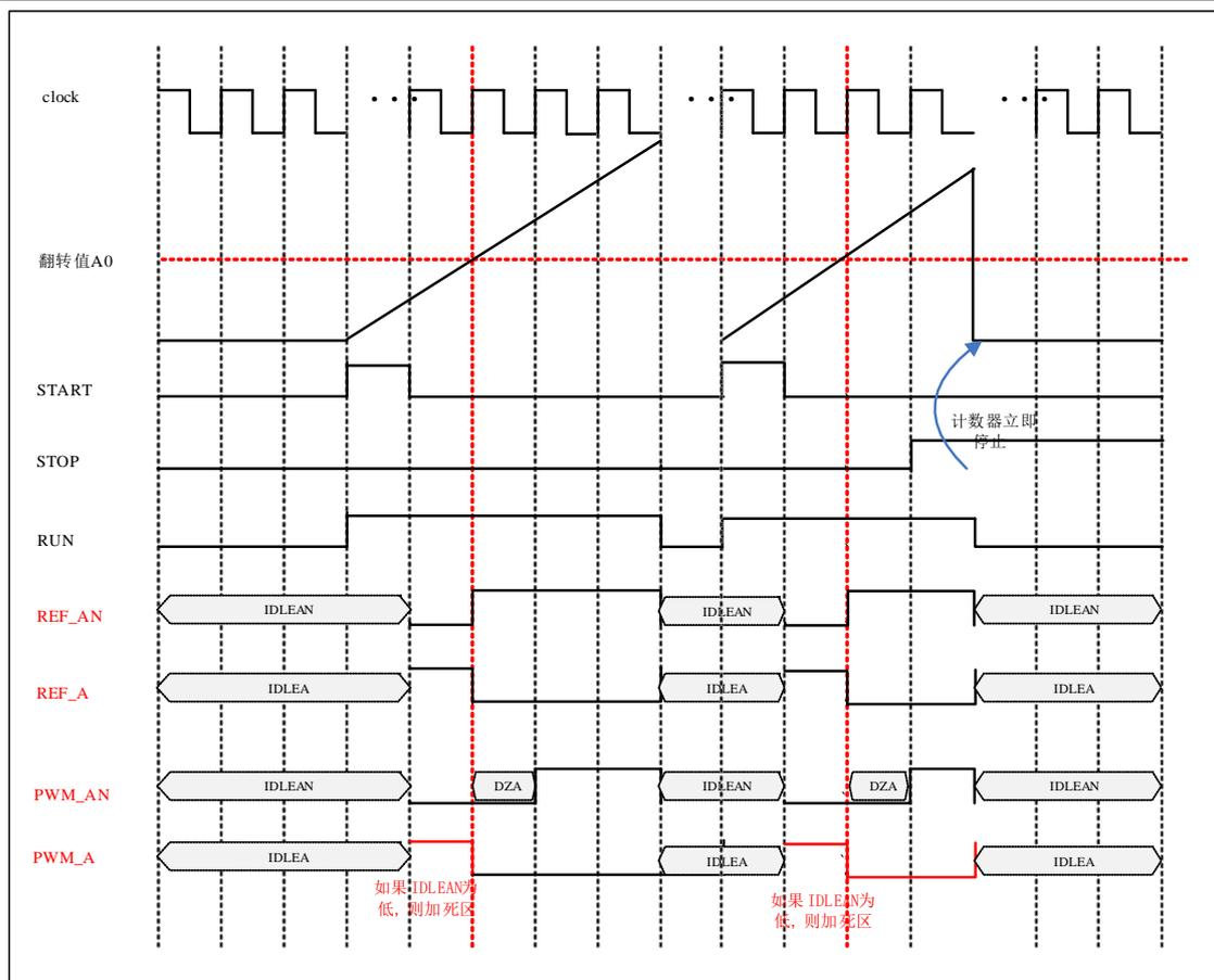
图 6-46 边沿对齐模式下向上计数时计数器启动与停止波形
