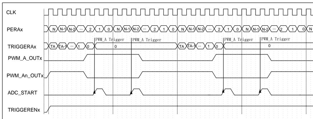
图 6-66 中心对称模式下 PWM 触发 ADC 采样示意图
