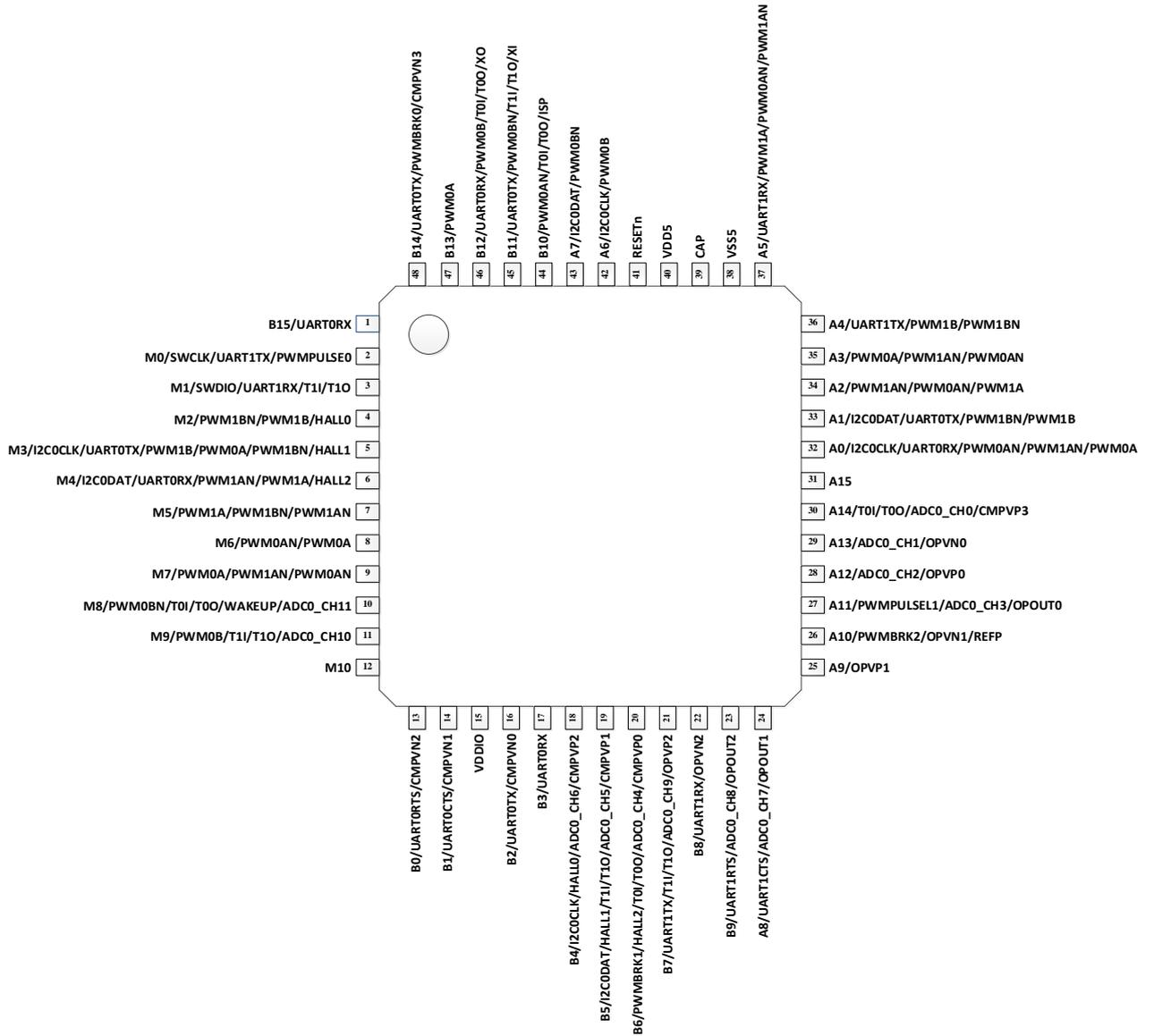
图 5-1 C6T7 封装管脚配置图
