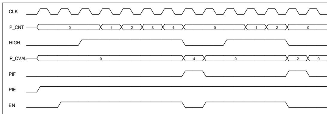
图 6-15 单次高电平捕捉示意图
