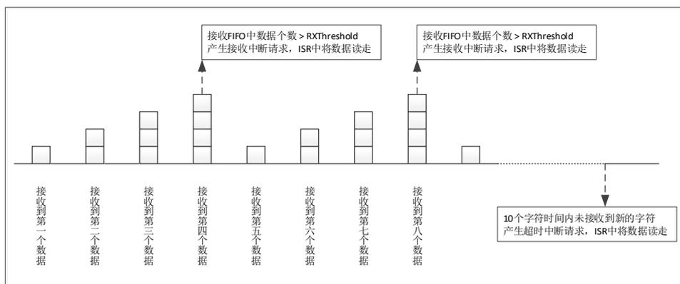
图 6-37 对方发送 9 个数据接收 FIFO 示意图
