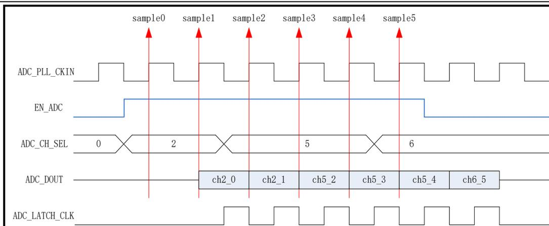
图 6-68 SAR ADC 多通道连续采样示意图
