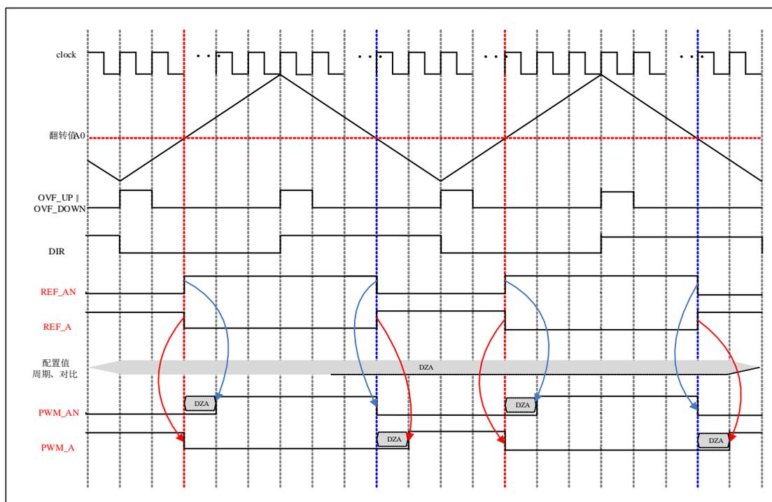
图 6-55 中心对齐模式下 PWM 信号产生波形
