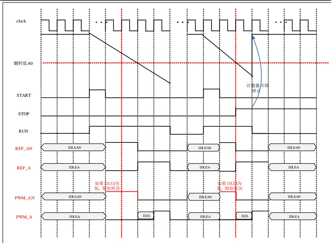
图 6-47 边沿对齐模式下向下计数时计数器启动与停止波形
