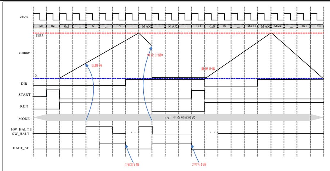
图 6-52 硬件刹车控制和软件刹车控制计数器计数情况
