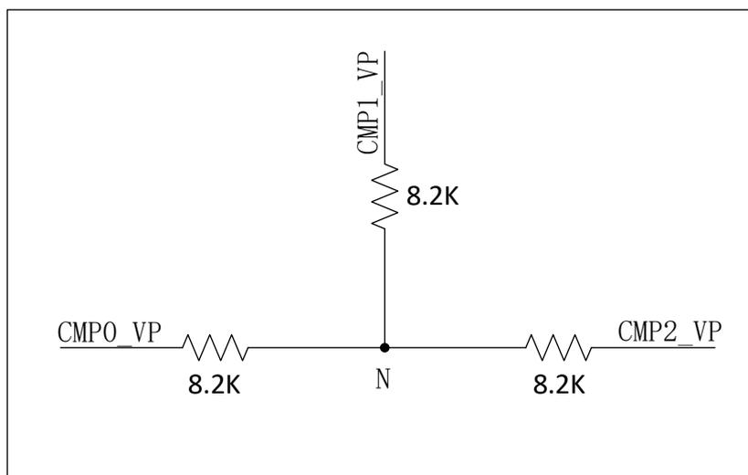
图 6-72 P 端分压模式结构示意图
