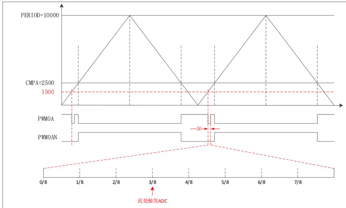
图 6-63 挖坑后波形
