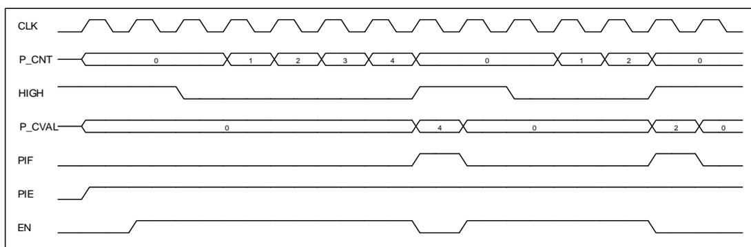
图 6-16 单次低电平捕捉示意图
