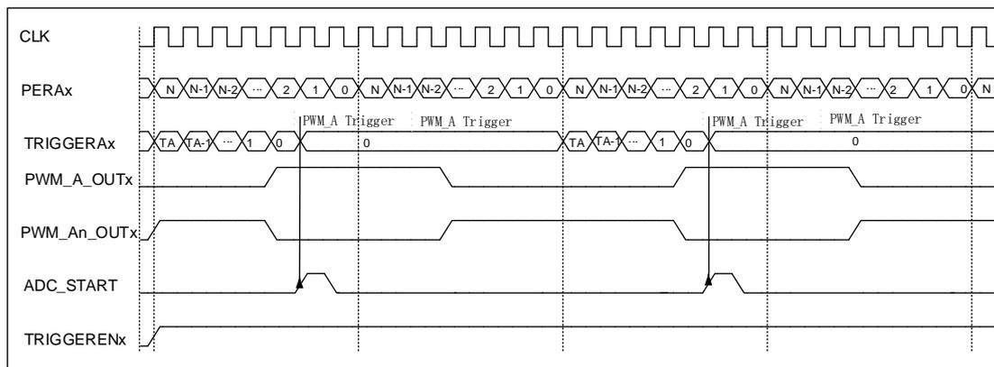
图 6-60 PWM 触发 ADC 采样示意图
