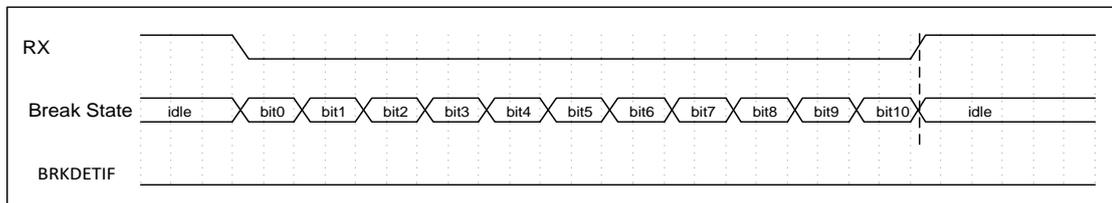
图 6-33 Break 信号恰好够长示意图
