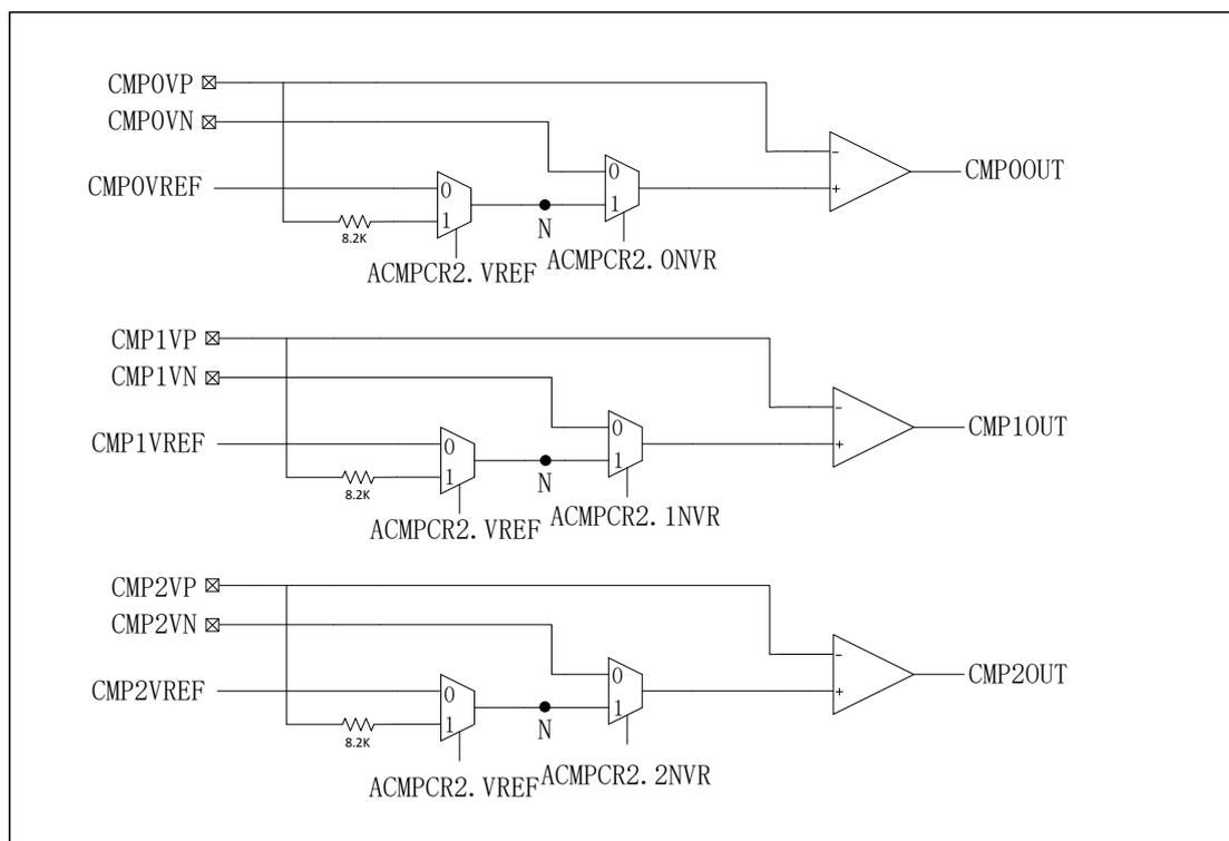
图 6-73 P 端分压模式结构图
