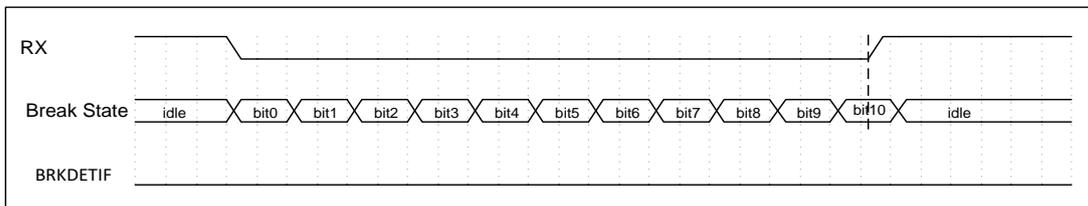
图 6-32 Break 信号不够长示意图
