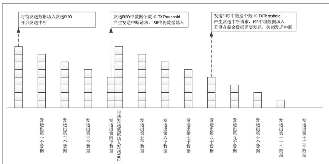
图 6-38 发送 FIFO 示意图
