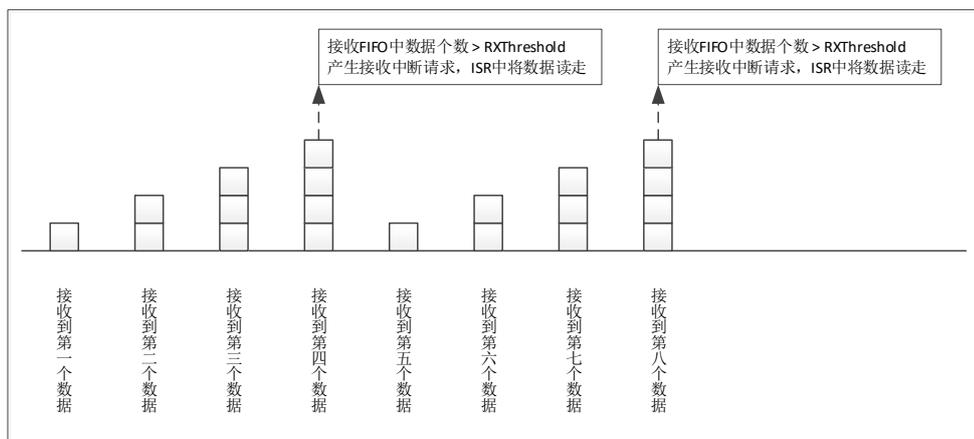
图 6-36 对方发送 8 个数据接收 FIFO 示意图
