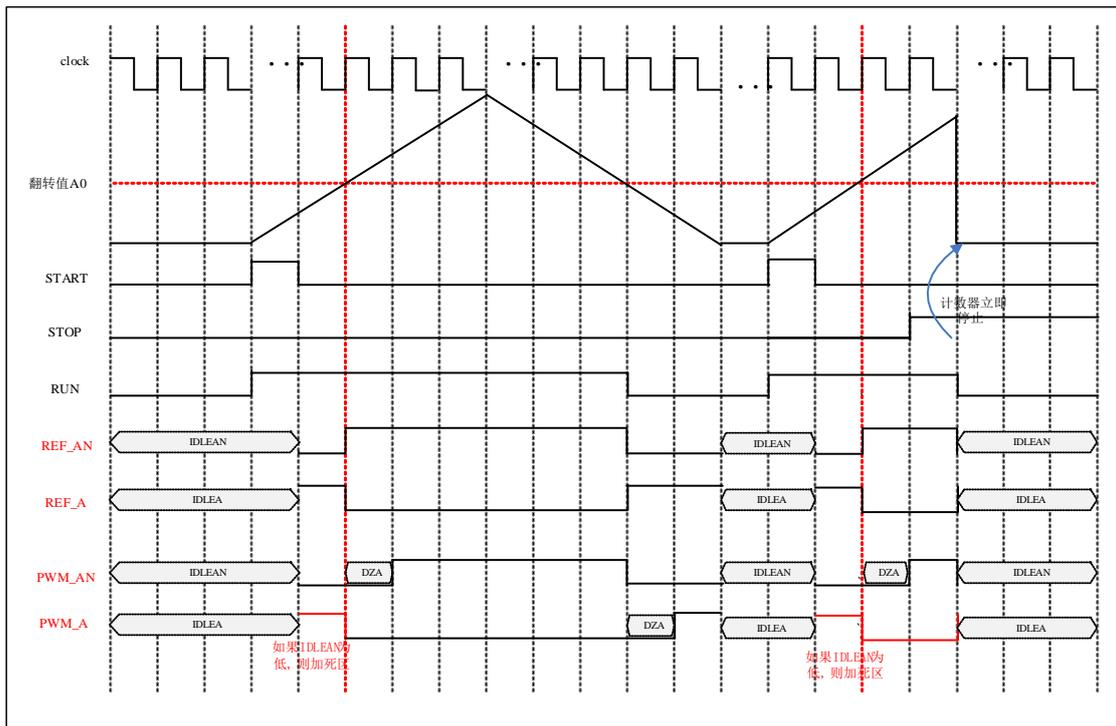
图 6-48 中心对齐模式下计数器启动与停止波形
