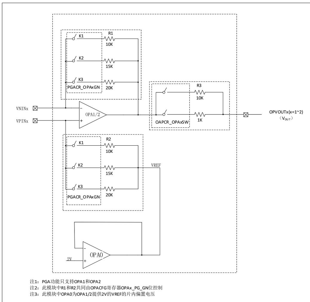
图 6-76 OPA1/OPA2 PGA 内部结构图
