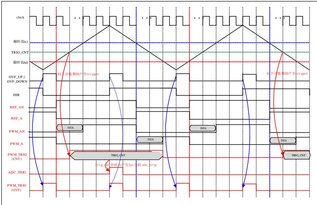
图 6-58 TRIGGER 控制波形
