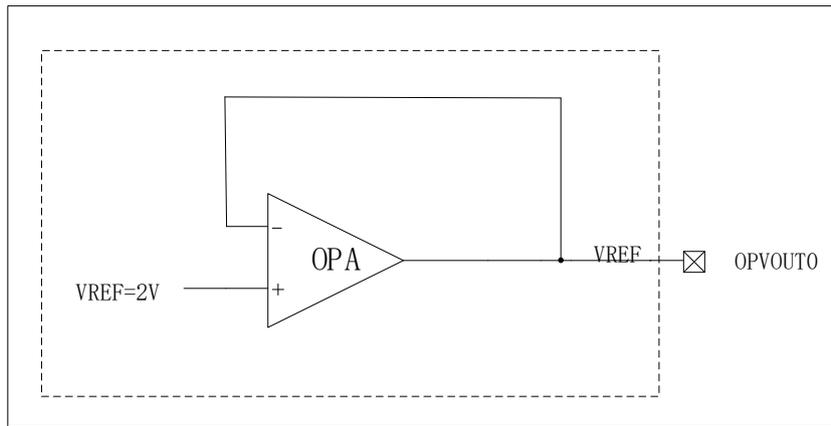
图 6-75 OPA0 基准模式内部结构图
