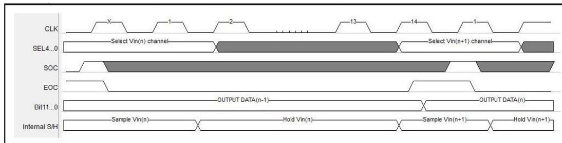
图 6-67 SAR ADC 连续采样示意图
