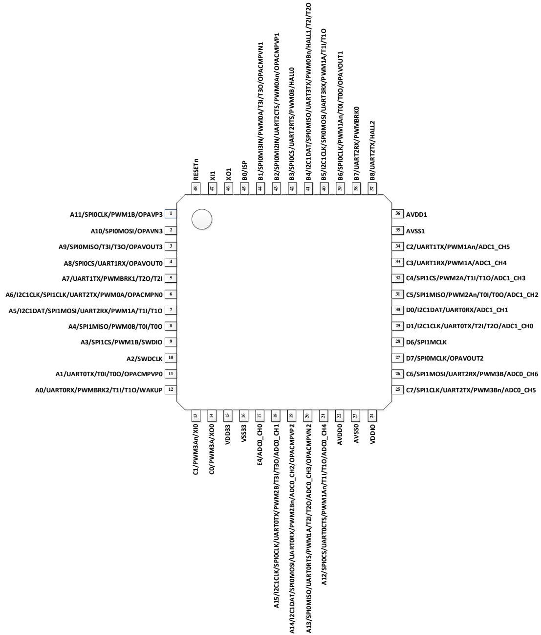
图 5-2 CBT7 封装管脚配置图
