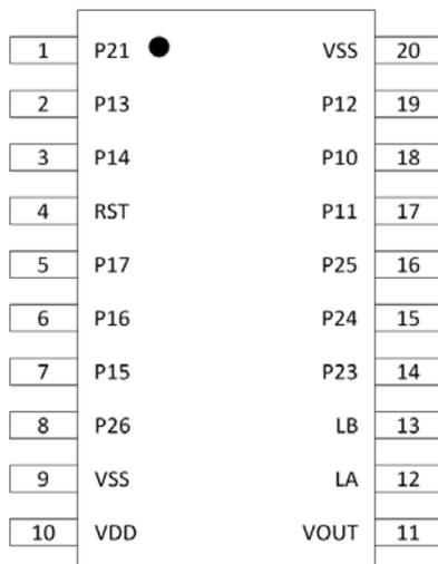
图 4.1 RJM8L303 TSSOP20 引脚封装
